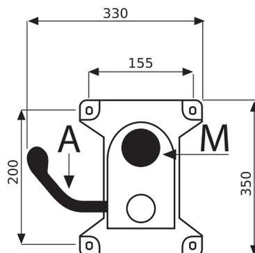
Meccanismo oscillante per monoscocca/poltrona con corpo in alluminio 5 posizioni di bloccaggio con sistema antiritorno dello schienale
