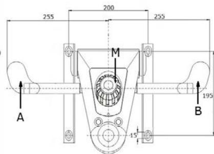
Meccanismo a fulcro avanzato per monoscocca/poltrona con corpo in alluminio, 5 posizioni di bloccaggio con sistema antiritorno dello schienale
