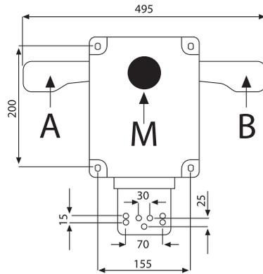
Meccanismo sincronizzato in acciaio sistema antiritorno schienale, 4 posizioni di bloccaggio
