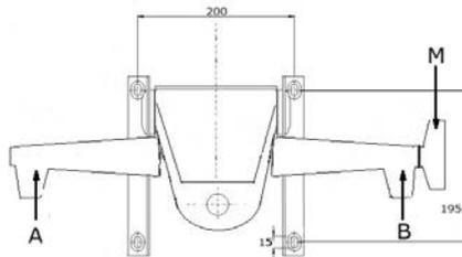
Meccanismo a fulcro avanzato per poltrona QUICK SHIFT tensionatore laterale, 4 posizioni bloccaggio sistema antiritorno dello schienale
