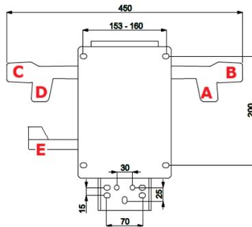
Meccanismo sincro con slitta sedile, tensionatore laterale QUICK SHIFT e Forward tilt, 4 posizioni di bloccaggio.
