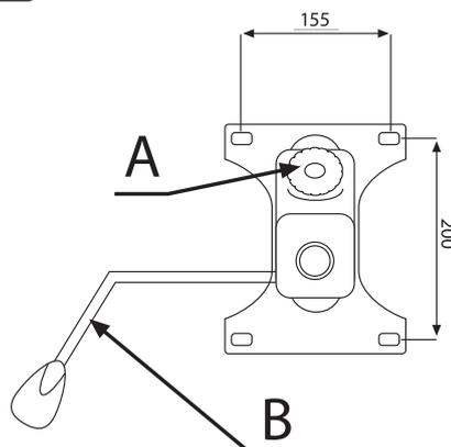
Meccanismo oscillante in acciaio, cono Ø 28 mm
