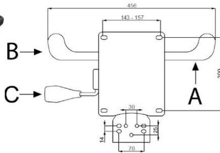
Meccanismo auto-pesante in acciaio con slitta sedile integrata, 4 posizioni di bloccaggio
