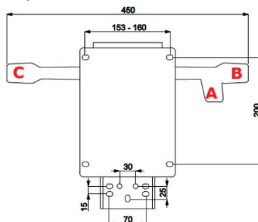
Meccanismo sincro con tensionatore laterale QUICK SHIFT, 4 posizioni di bloccaggio.
