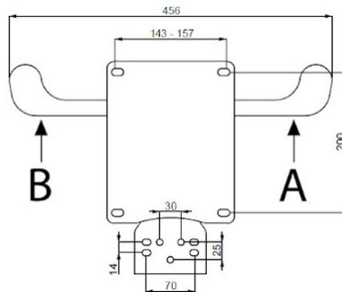
Meccanismo auto-pesante in acciaio, 4 posizioni di bloccaggio
